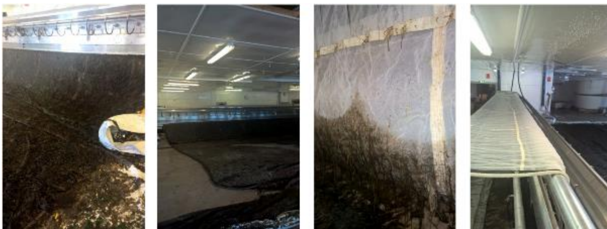
Figur 3: Vaskemaskin for luseskjørt med roterende dyser (Foto: Remi Mathisen, Nordlaks Oppdrett AS).
